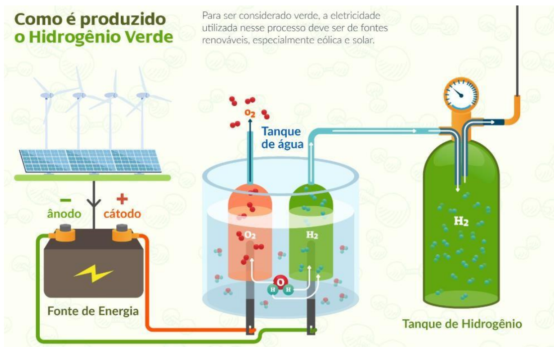
Figura 3 - Esquemática da produção de hidrogênio verde com energia renovável
