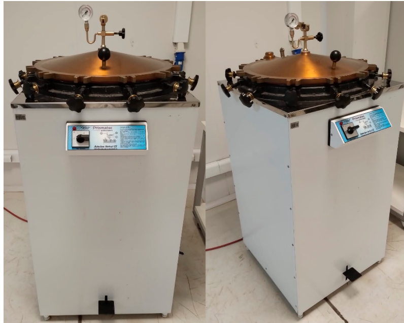
Figura 13 –Vista frontal e diagonal de uma autoclave vertical de 300L
