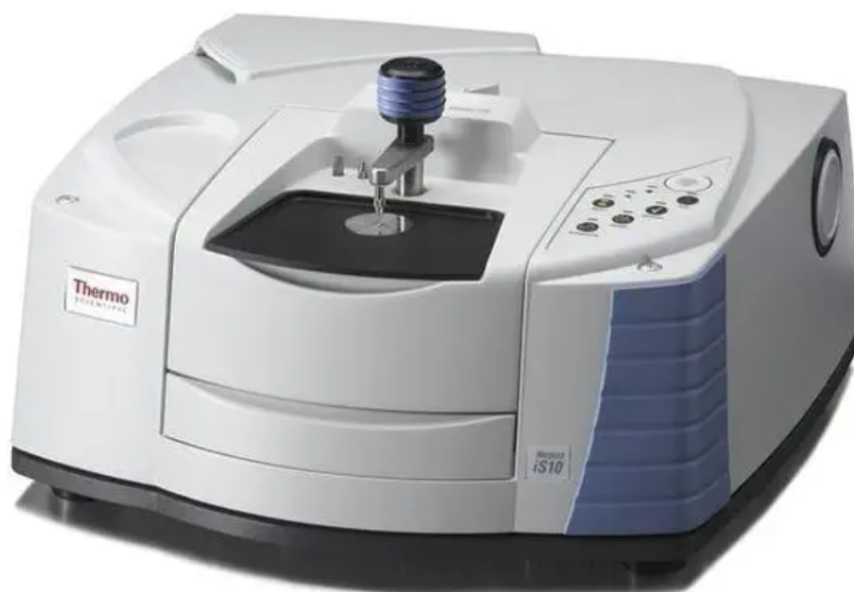
Figura 11 - Equipamento de FTIR Nicolet iS10 da Thermo Scientific.
