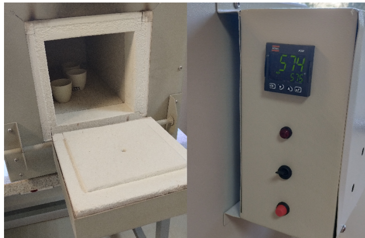
Figura 9 – Forno mufla utilizado neste estudo e seu painel de temperatura.
