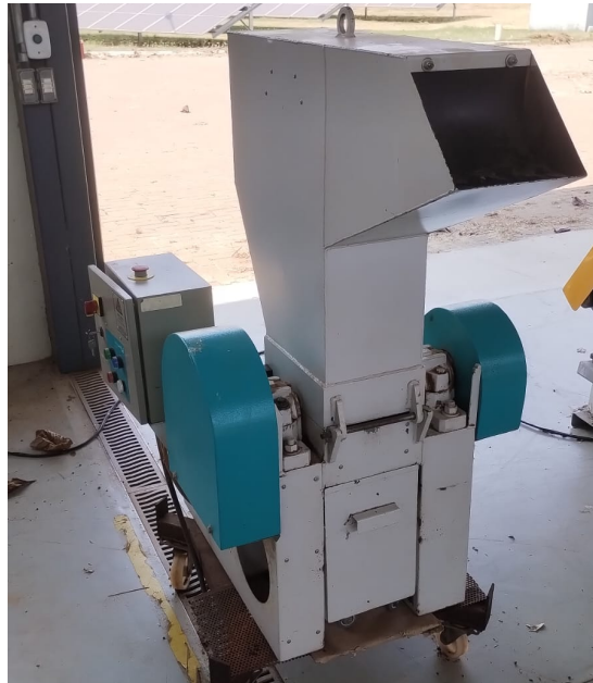
Figura 6 - Moinho de facas da Marconi, modelo MA683/8
