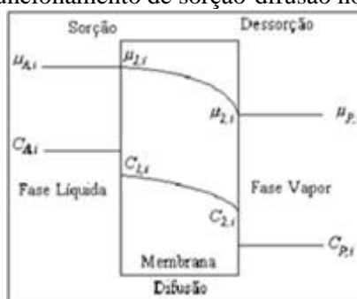
Figura 5 - Ilustração do funcionamento de sorção-difusão no processo de pervaporação
