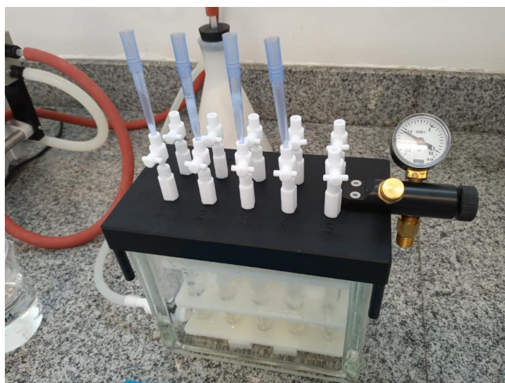
Figura 8 - Manifold – Aparato utilizado para filtração à vácuo.
