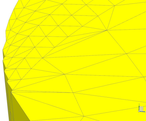
Figura 38 - Distorção da malha na zona de corte
