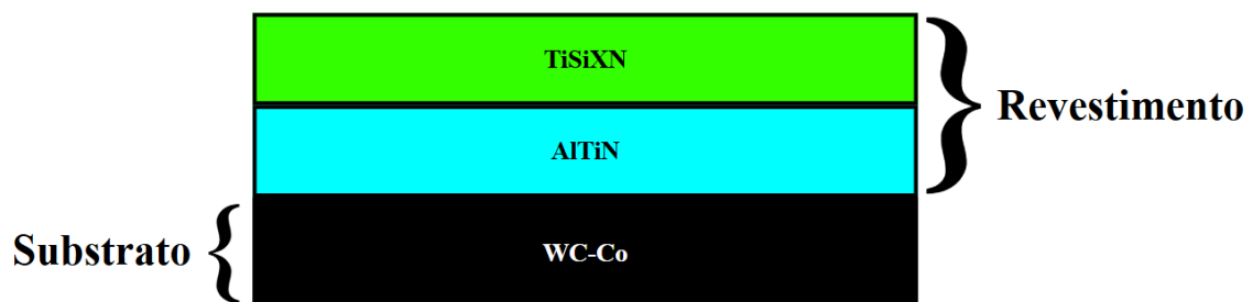
Figura 19 - Disposição das camadas do revestimento Balinit Durana
