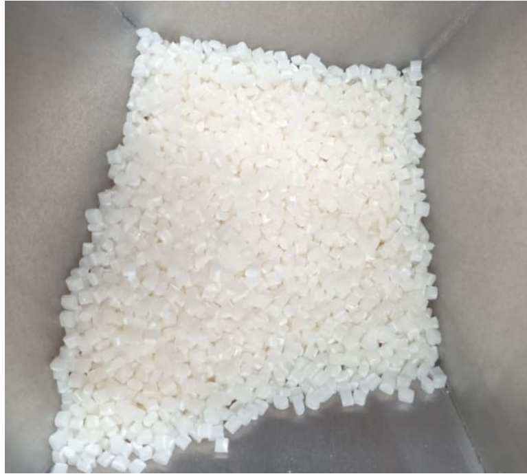
Figura 31 – Foto dos pellets no funil da extrusora.
