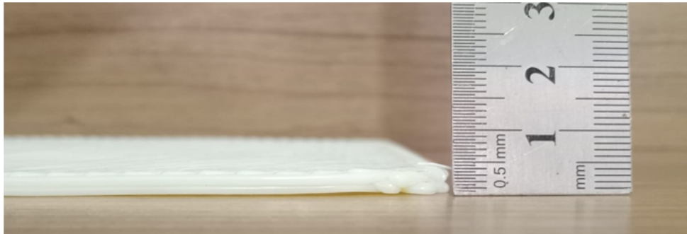
Figura 47 – Foto do empenamento do Teste-4.
