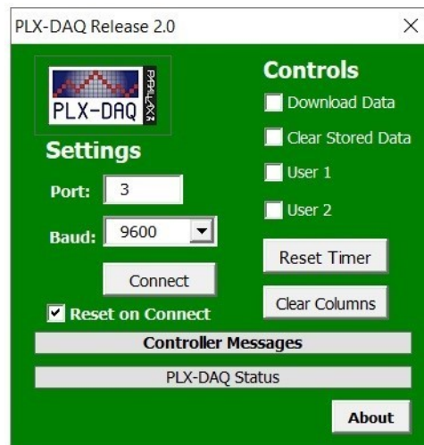
Figura 29 – Programa auxiliar de comunicação entre o Arduino e o Excel.
