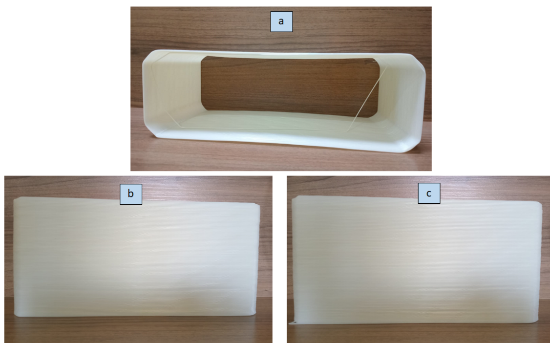
Figura 54 – Resultado do Teste-4. Impressões com aquecimento bidirecional por Lâmpadas infravermelhas móveis.
