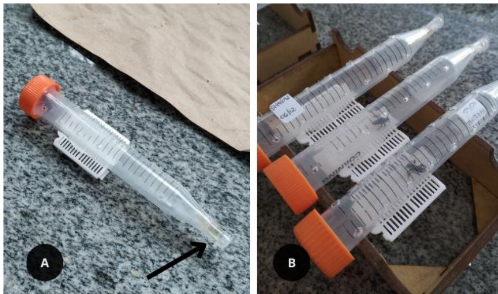
Figura 4 - (A) Novo recipiente para aclimação dos indivíduos, feito com tubo Falcon de 15 mL e microtubo (seta) na extremidade para oferta ad libitum do alimento. (B) Indivíduos de Tetrapedia diversipes em aclimação no novo recipiente.
