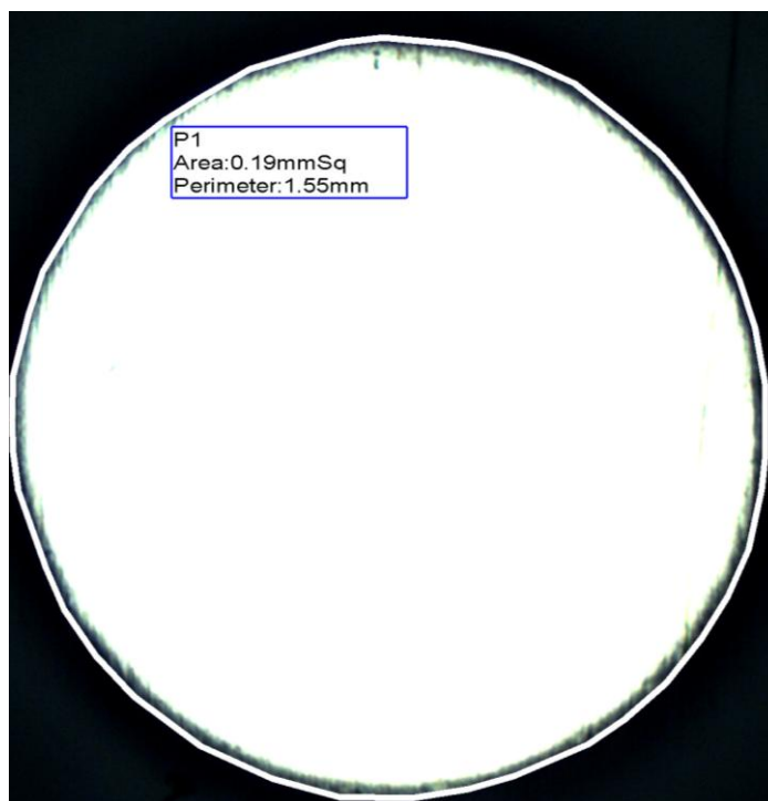
Figura 10 - Medição de área de eletrodo de platina sob lente 200x
