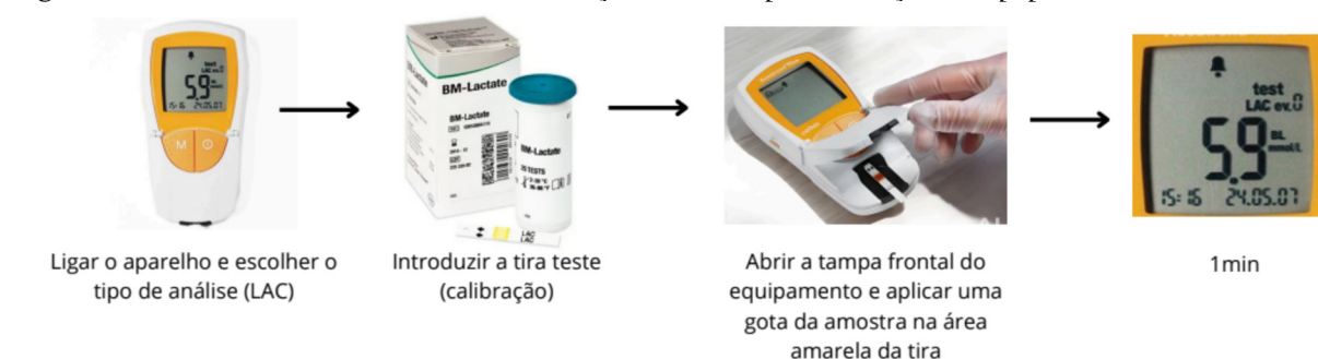
Figura 13 - Procedimento de análise da concentração de lactato pela utilização do equipamento lactímetro.
