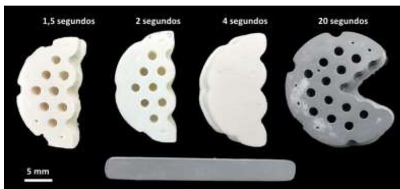
Figura 4.16: Influência do tempo de exposição no espalhamento de luz UV. As amostras brancas representam formulações de alumina contendo \text{Nb}_2\text{O}_5 e as peças cinzas correspondem aquelas contendo alumina e \text{MnO}_2\text{-TiO}_2 . Fonte: Próprio autor.
