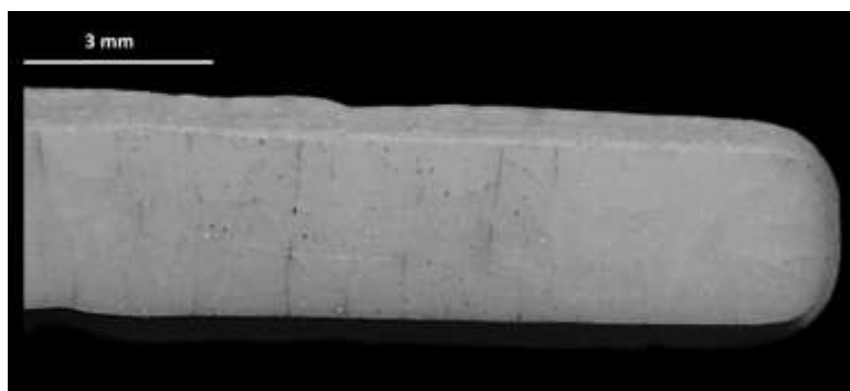
Figura 4.20: Trincas superficiais aparente na amostra A-50-Nb sinterizada em 1600°C/2h.
