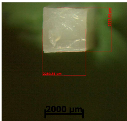
Figura 9 - Detalhe da seção dos filamentos extrudados com a matriz.
