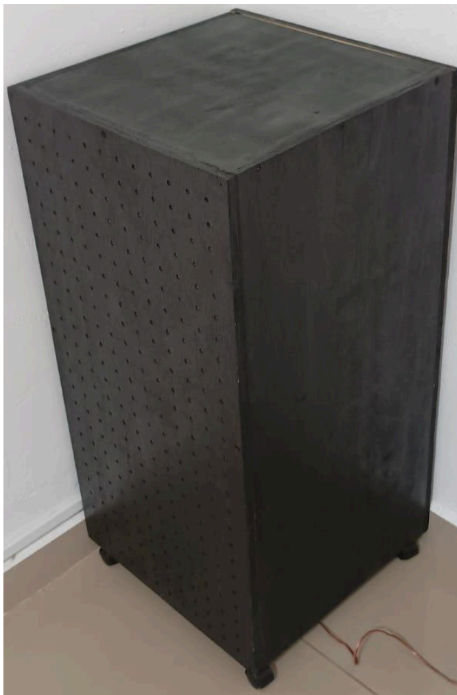
Figura 35: Ressorador de Helmholtz pronto.
