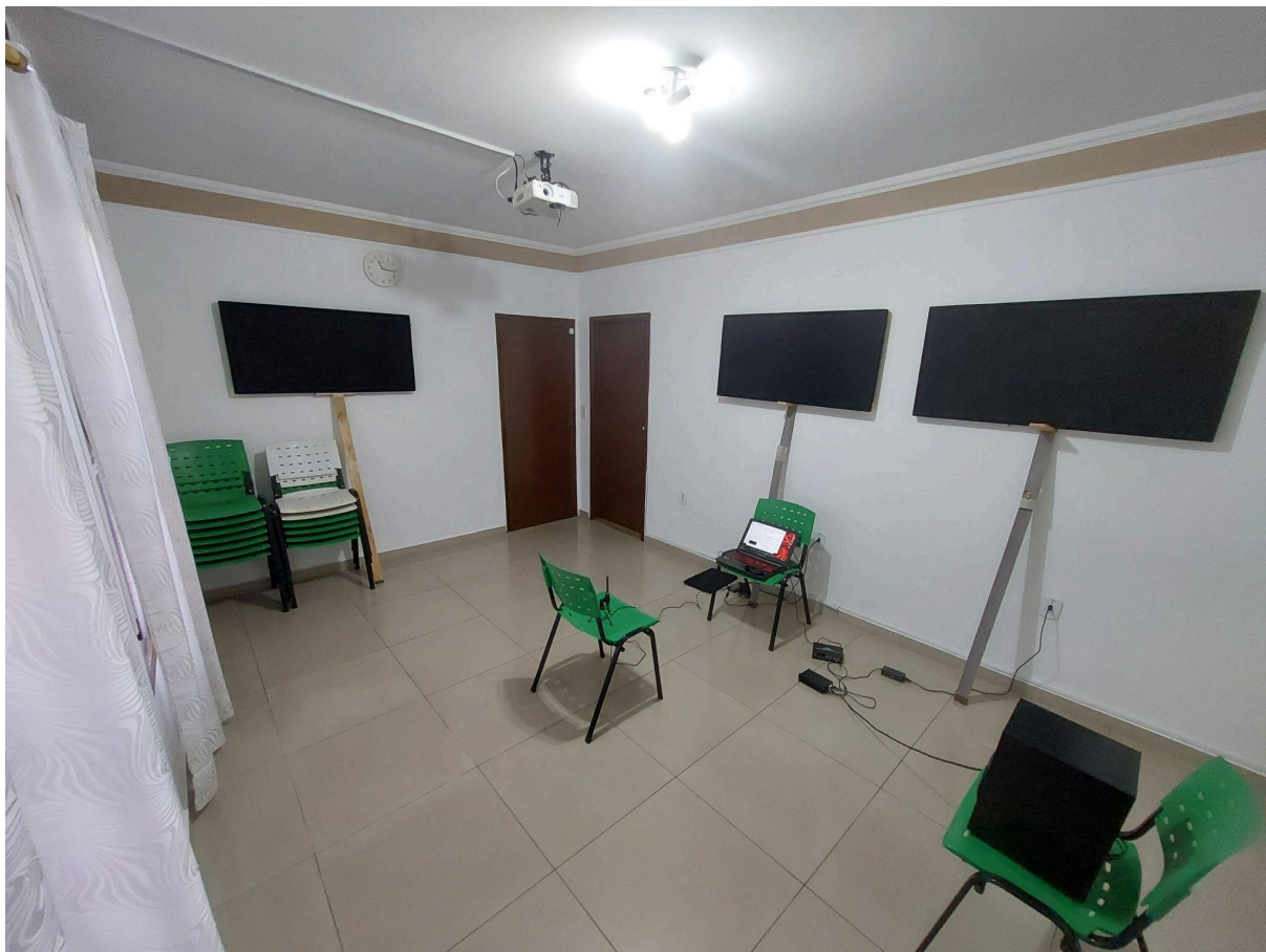
Figura 22: Sala trabalhada e distribuição dos absorvedores, microfone ao centro.
