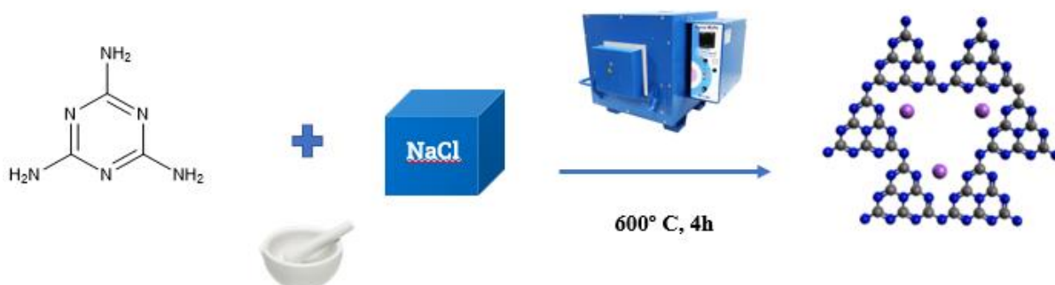
Figura 6: Síntese ionotérmica empregada para obtenção de estruturas PHI de nitretos de carbono. O precursor, melamina, e o sal utilizado NaCl estão na proporção 1:10. Após o tratamento térmico na mufla, íons \text{Na}^+ (em lilás) aparecem na estrutura do nitreto como single-atoms .
