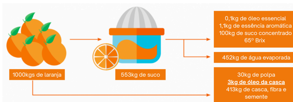
Figura 14 – Processamento da laranja e seus subprodutos.
