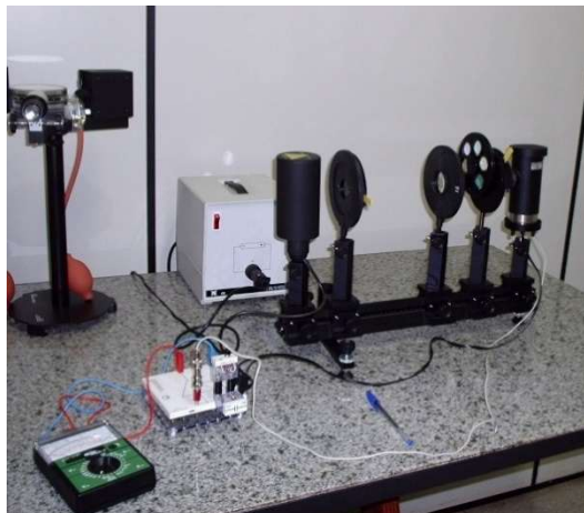
Figura 1.2 – Banco óptico para a determinação da constante de Planck e aparelho para a execução da experiência de Millikan.
