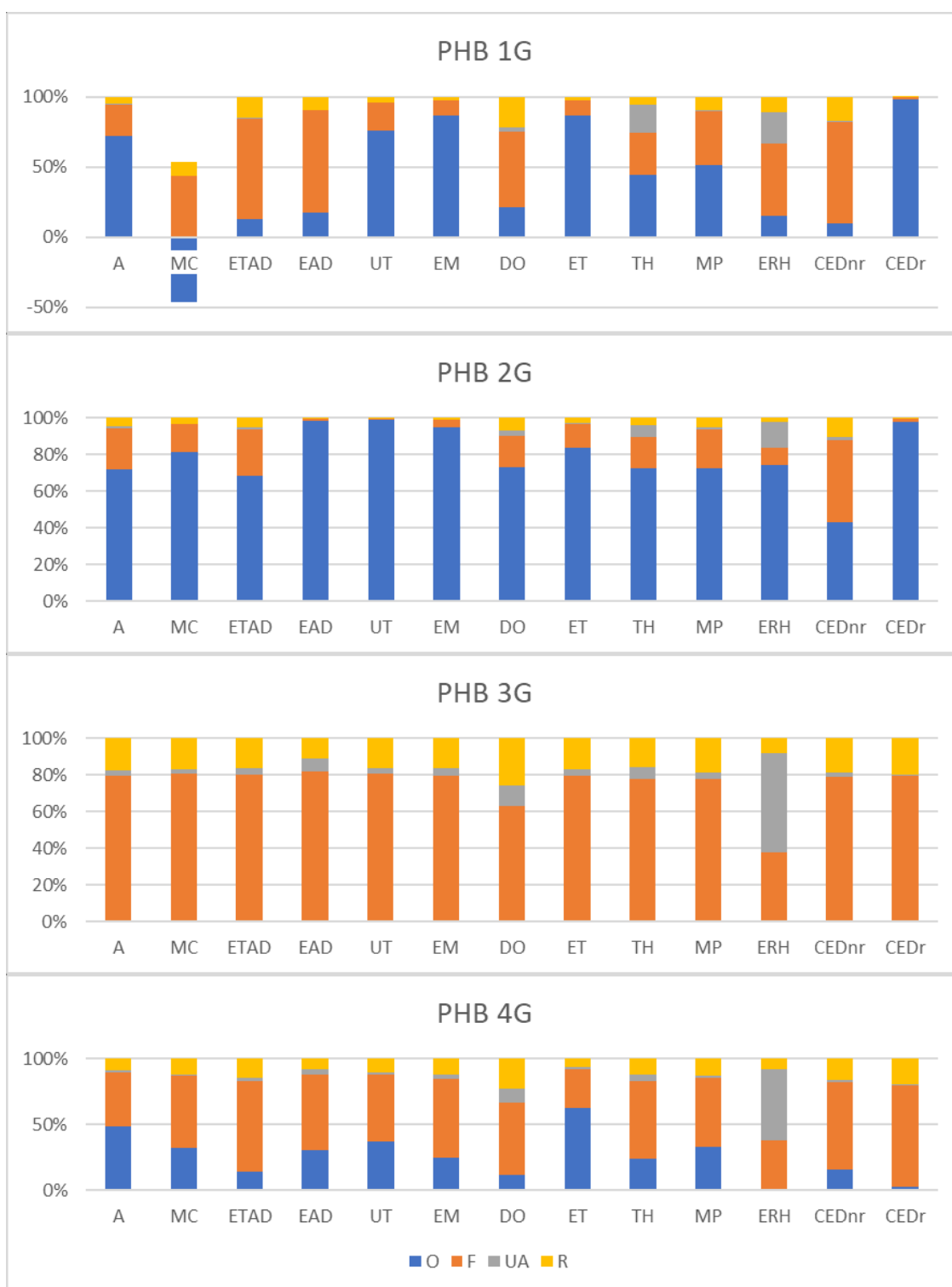
Figura 4.2: Resultados de impacto ecológico relativo da produção de PHB, por biomassa - cana-de-açúcar (1G), óleo vegetal pós-consumo (2G), efluente líquido doméstico (3G) e biogás de resíduo não-perigoso (4G) -, indicador e etapa do processo - obtenção de biomassa (O), fermentação de biomassa (F), uso de água (UA), recuperação de PHBV (R).
