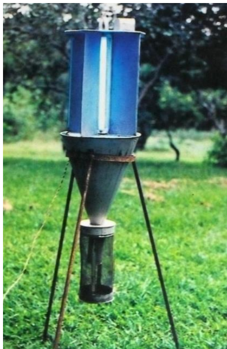
Figura 11: Armadilha Luminosa Luiz de Queiroz adaptada
