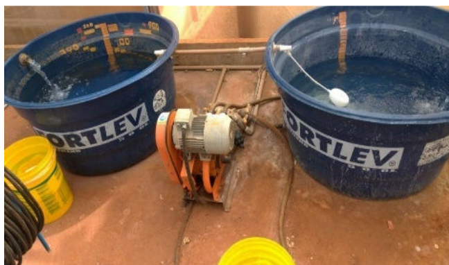
Figura 31- Reposição da solução nutritiva das Caixas A (esquerda) e B (direita) para fertirrigação através do ejetor de fertilizantes (centro) das plantas do Telado do Cultivo Protegido de Citros. Acervo pessoal, 2024.
