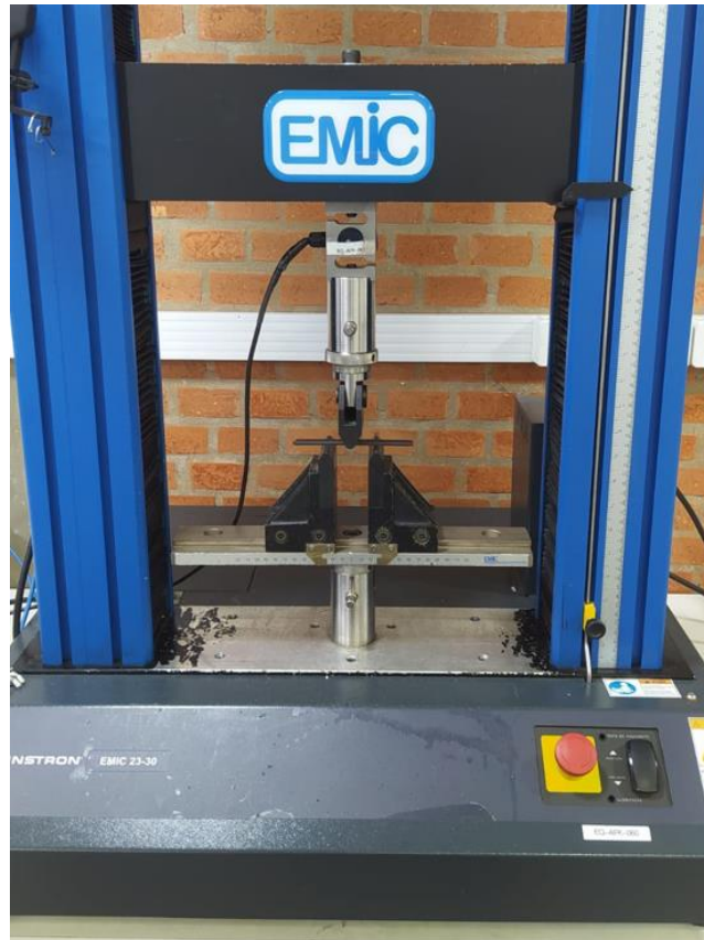
Figura 27: Máquina Universal de Ensaio Instron EMIC, realizando um ensaio de Flexão.
