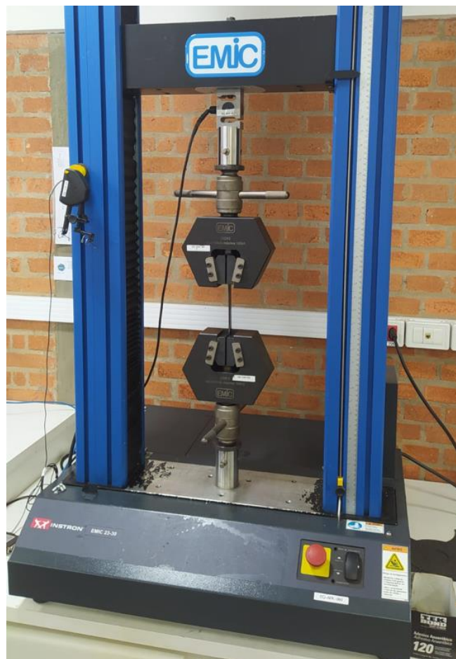
Figura 25: Máquina Universal de Ensaio Instron EMIC, realizando um ensaio de Tração.
