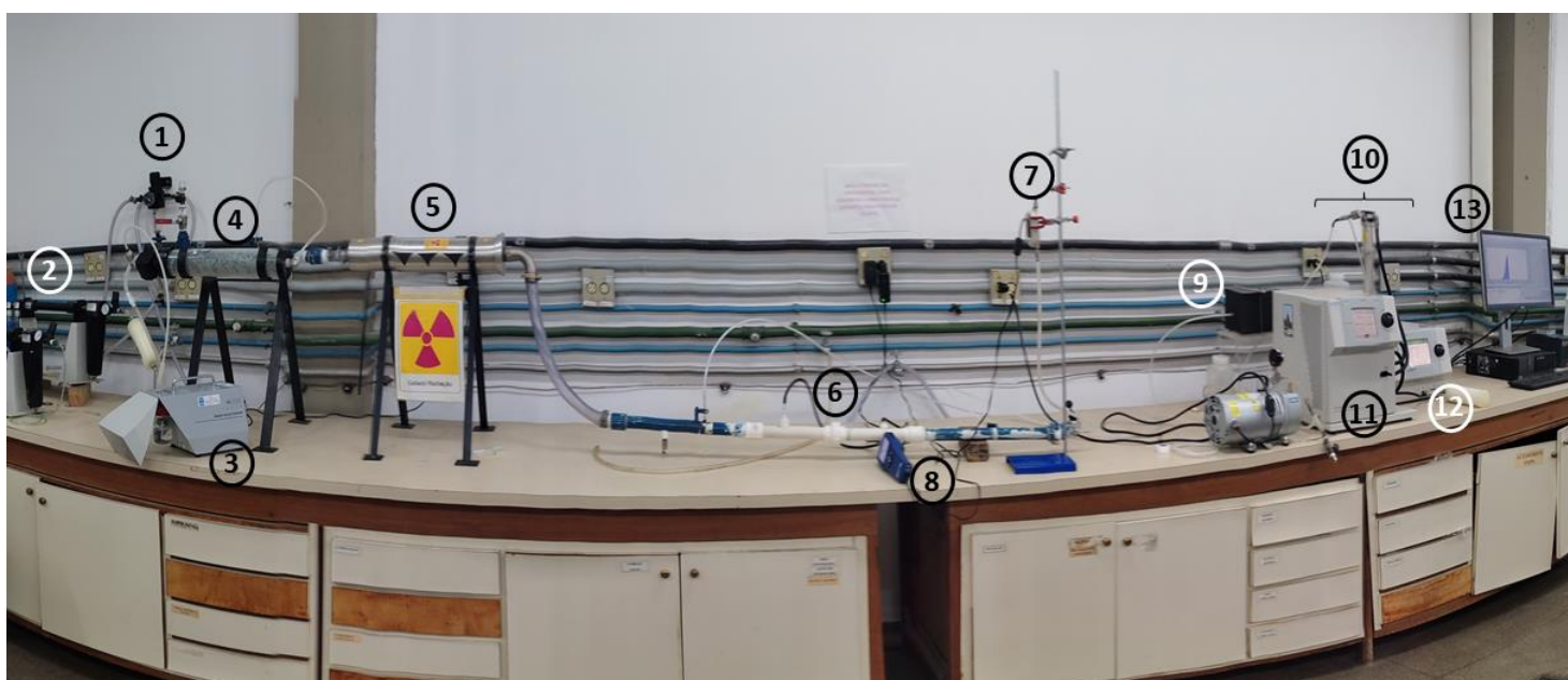
Figura 3.9 - Módulo experimental para os ensaios de filtração: linha SMPS.
