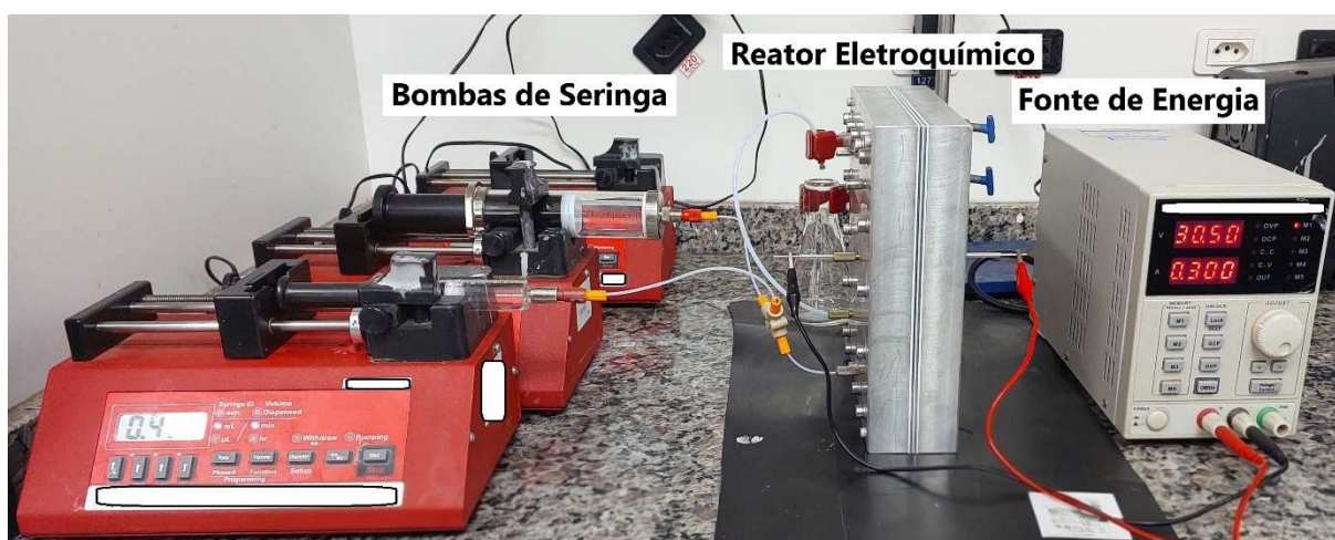
FIGURA 3.15. Setup reacional para a síntese 13 em regime de fluxo contínuo.
