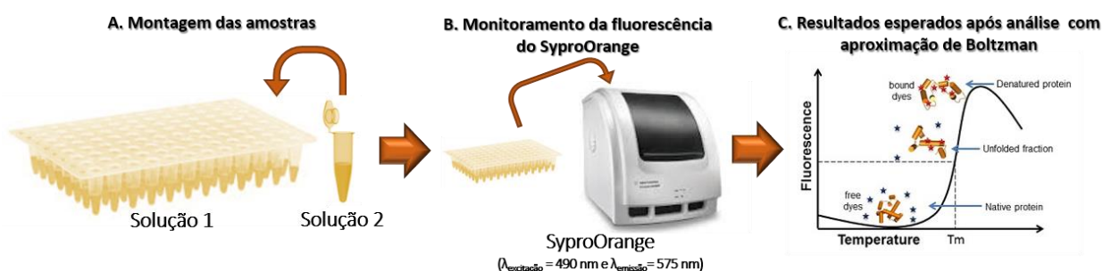
FIGURA 5.1. Esquema mostrando as etapas do ensaio para análise da estabilidade térmica do domínio helicase da NS3 de ZIKV.
