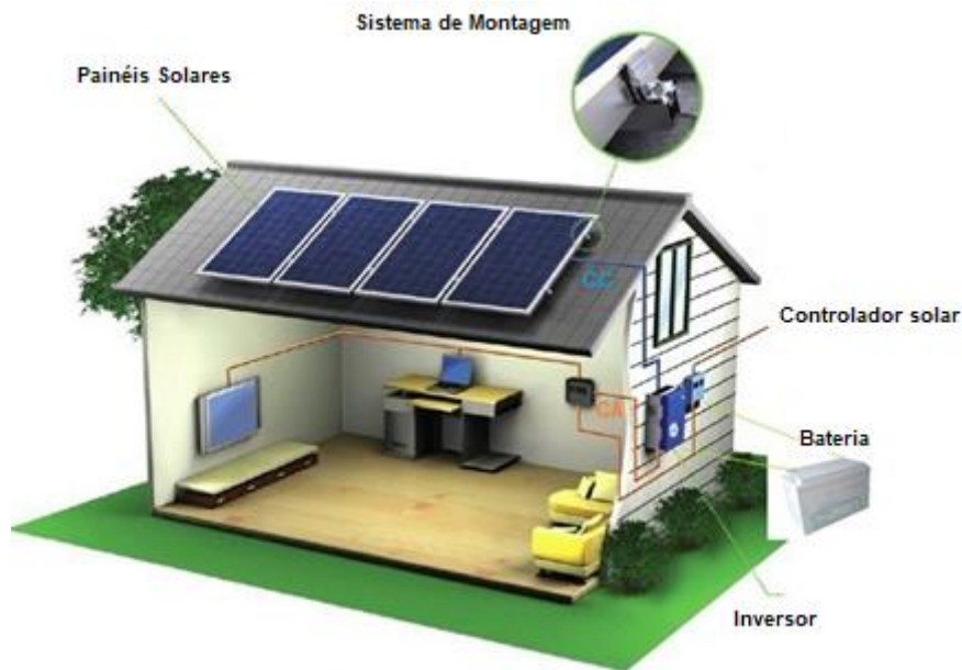
Figura 10 - Sistema fotovoltaico off-grid [Adaptada de 13].
