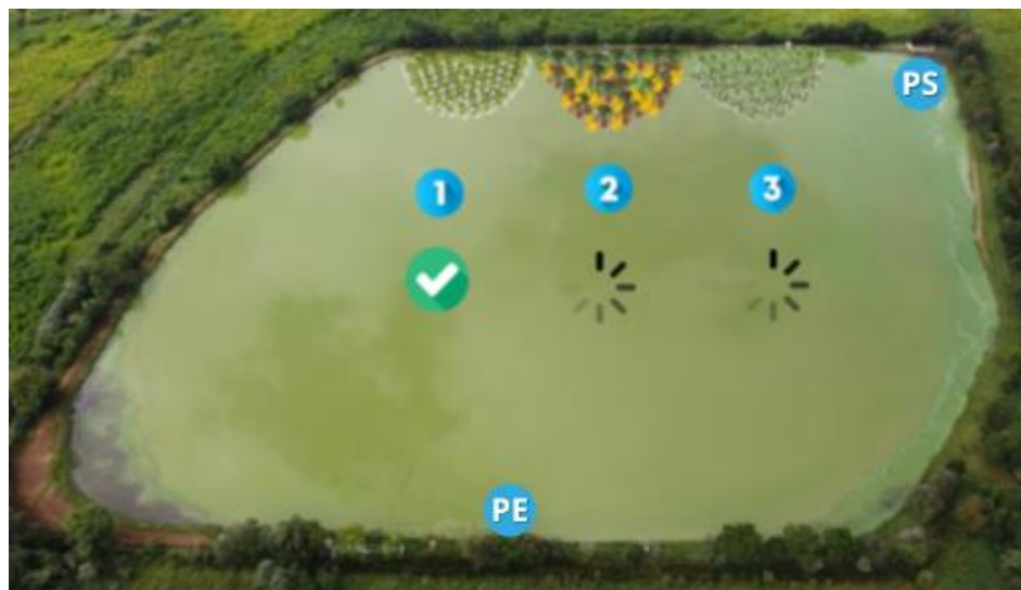
Figura 5 - Área piloto da fitorremediação na lagoa (1) e a perspectiva de expansão (2) e (3) em relação ao ponto de entrada do efluente bruto (PE) e ao ponto de saída do efluente tratado (PS).
