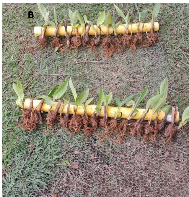
Figura 10 – Estrutura utilizada para inserir as espécies Cyperus alternifolius L. (A) e Canna x generalis (B) em suspensão na superfície da lagoa.
