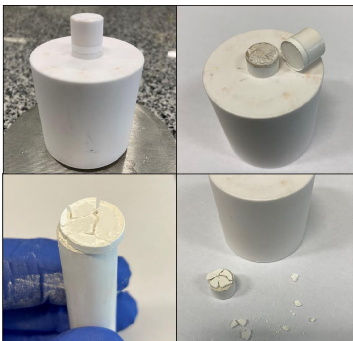
Figura 5.27 - Falhas ocorridas no processo de sinterização em prensa quente
