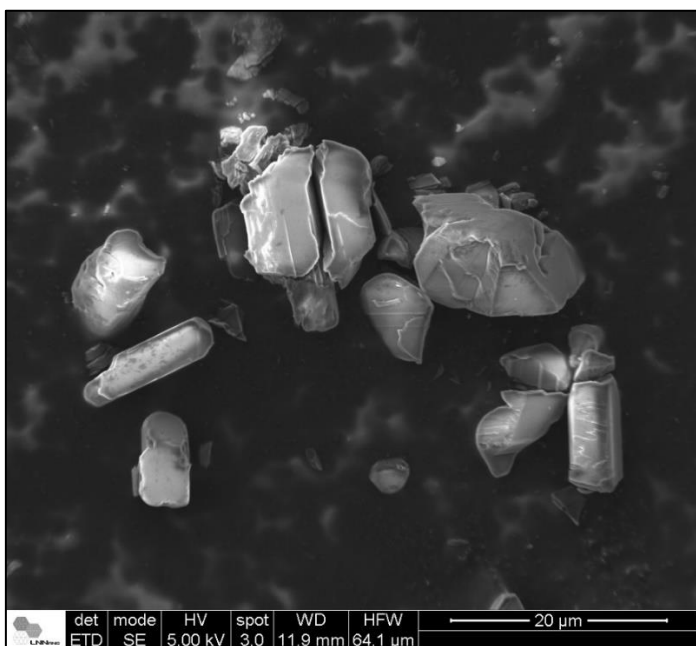
Figura 5.6 - Imagem de elétrons secundários de MEV do dióxido de zircônia (ZrO 2 )
