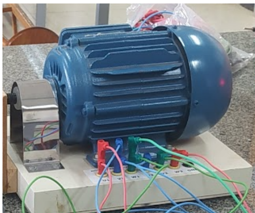
Figura 6: Motor trifásico Weg utilizado no projeto.
