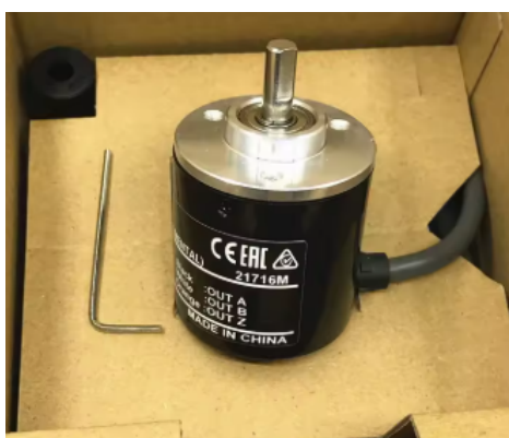
Figura 17: Encoder utilizado modelo e6b2-cwz1x 2500p.
