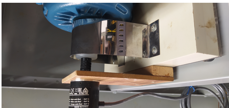
Figura 20: Encoder acoplado no motor com suporte finalizado.
