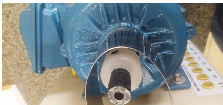
Figura 18: Flange e bucha flexível acoplado ao motor.
