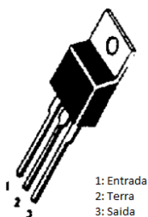
Figura 39: Esquemático regulador de tensão Lm7805.
