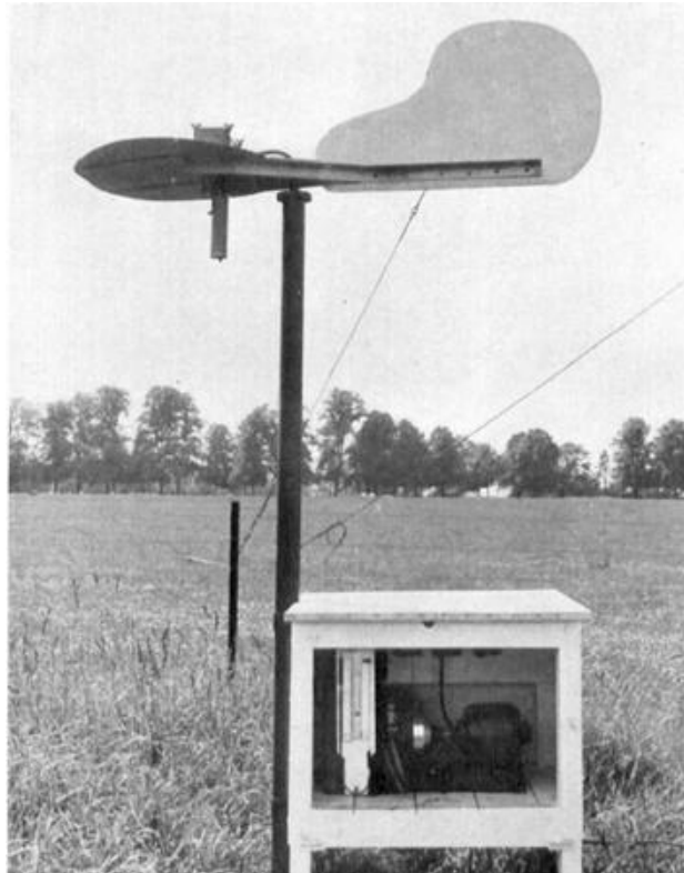
Figura 2: Amostrador volumétrico do tipo Hirst para coleta de bioaerossóis.
