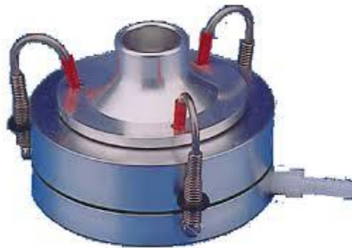
Figura 4: Amostrador Andersen de estágio único.
