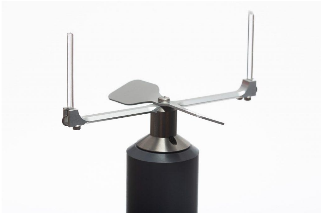
Figura 3: Amostrador do tipo Rotorod utilizado para a coleta volumétrica de bioaerossóis.
