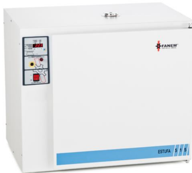
Figura 9: Estufa de bancada projetada para operações de secagem e esterilização, com faixa de temperatura ajustável de 50°C a 250°C.
