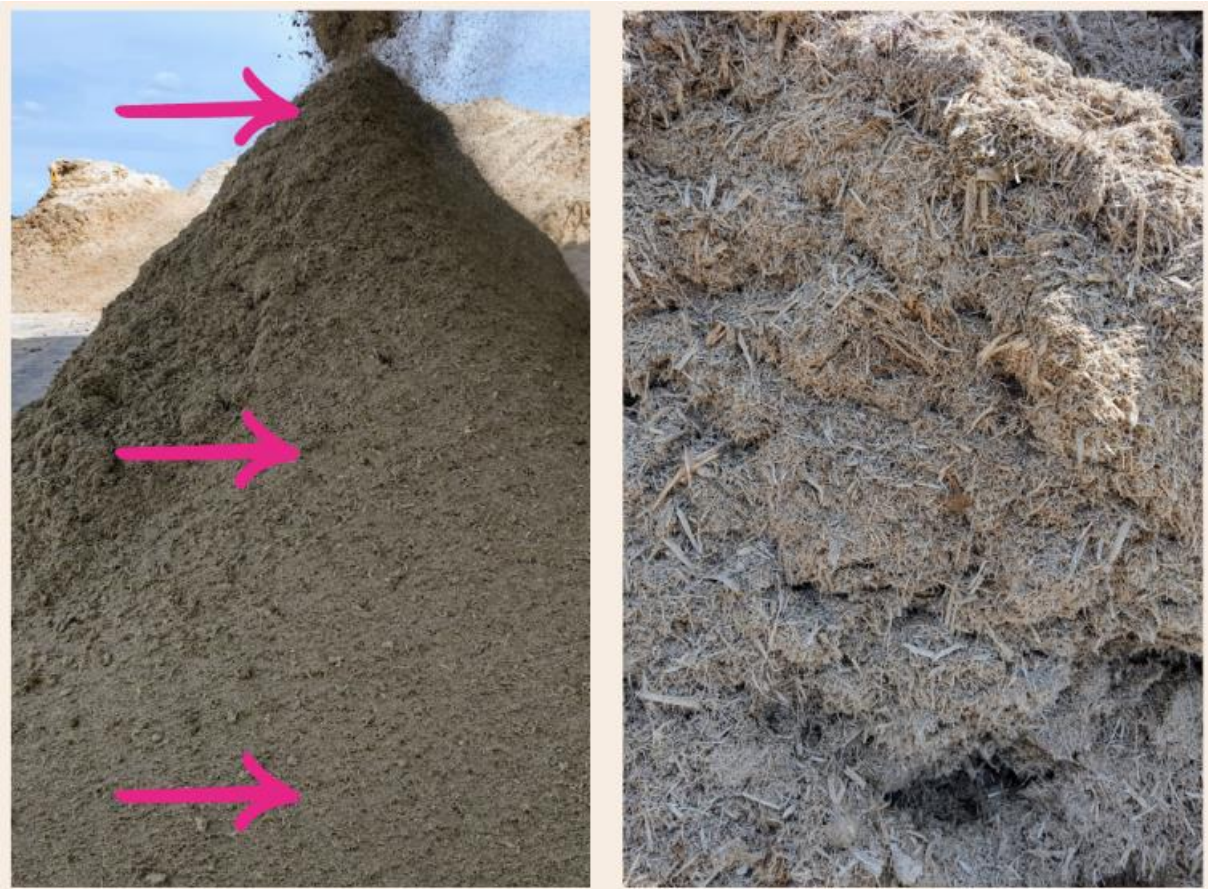
Figura 8: Amostragem para caracterização do bagaço de cana-de-açúcar diretamente do monte
