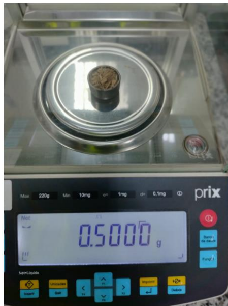
Figura 12: Preparação da amostra para ensaios em bomba calorimétrica digital
