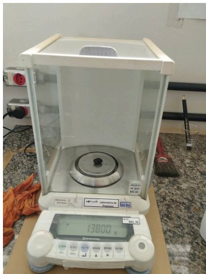
Figura 5 – Balança de precisão utilizada para medir a massa dos frutos de Syagrus romanzoffiana durante o processamento das amostras.
