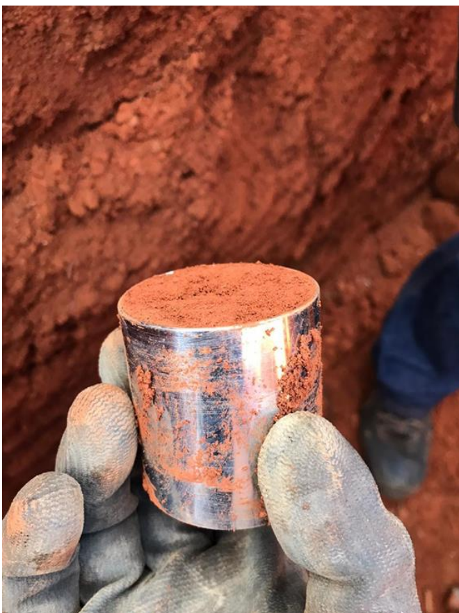
Figura 4. Anel volumétrico para coleta de amostras indeformadas.
