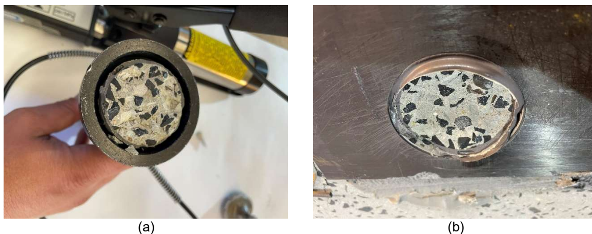
Figura 139 – Modo de ruptura no ensaio pull-off
