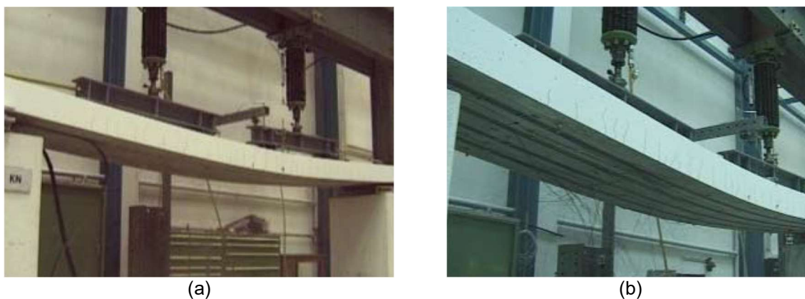
Figura 38 – Modos de ruptura observado por Garcez (2007)
