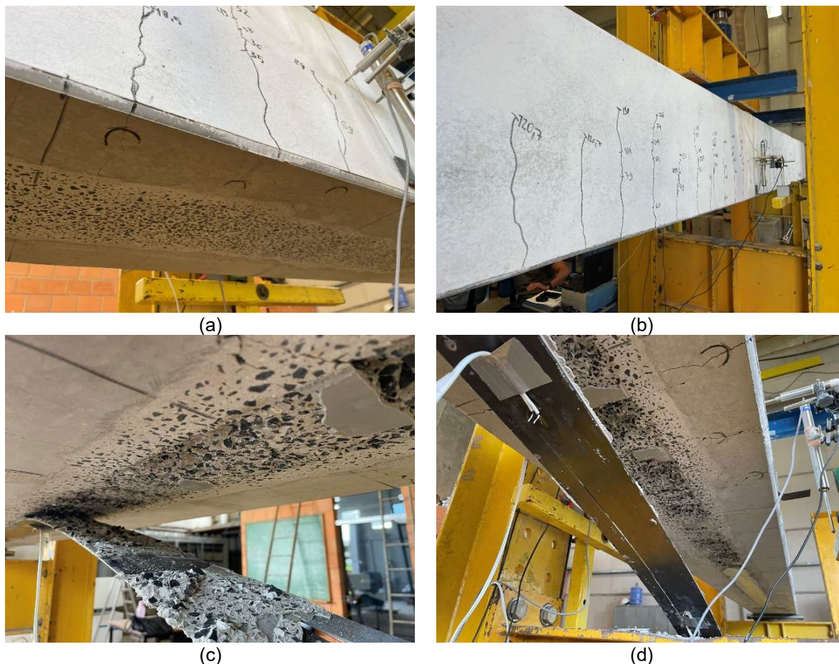
Figura 126 – Pré-fissuração e modo de ruptura da viga B3-PC-NP
