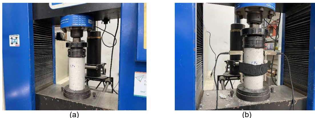
Figura 65 – Etapas dos ensaios de compressão axial e módulo de elasticidade do concreto
