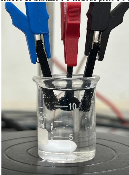
Figura 8. Sistema eletroquímico. O conector azul é referente ao eletrodo de pseudo-referência, o conector vermelho é o eletrodo de trabalho e o eletrodo preto é o eletrodo auxiliar
