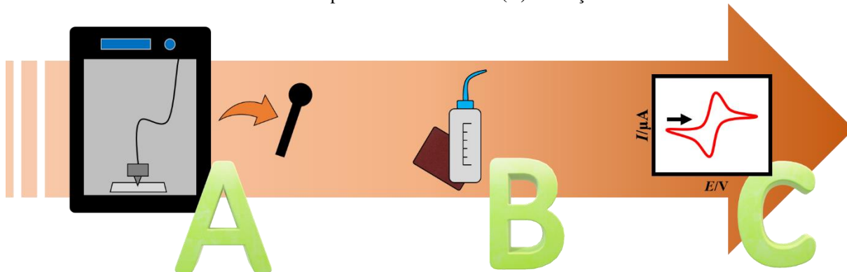
Figura 7. Processo de produção dos sensores eletroquímicos. (A) Manufatura aditiva dos eletrodos. (B) Tratamento mecânico da superfície dos eletrodos. (C) Obtenção do sinal analítico
