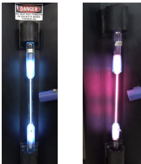
Figura 36 - (esq.) Foto tirada da lâmpada de Argônio e Mercúrio submetida a 5 kV (dir.) Foto tirada da lâmpada de Hidrogênio submetida a 5 kV.
