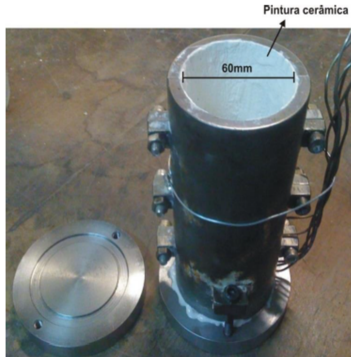
Figura 3.6: Lingoteira de aço inoxidável AISI 310 com chapa-molde (parte inferior) de aço carbono 1020 [124].
