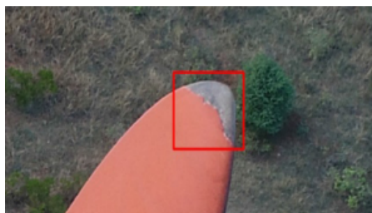
Figura 1 – Detecção de erosão na ponta de um aerogerador [Reddy et al. 2019].
