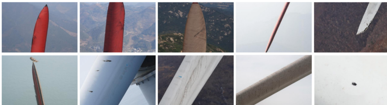
Figura 15 – Imagens com vários defeitos (parte superior) e contaminações (parte inferior) presentes no conjunto de dados Blade30. Vários defeitos, entre eles, rachaduras na borda, rachaduras na superfície vermelha e na superfície branca causadas por trovões, erosão na borda principal. Contaminações diversas como manchas de óleo, manchas de areia aderida, etc [Yang et al. 2023].
