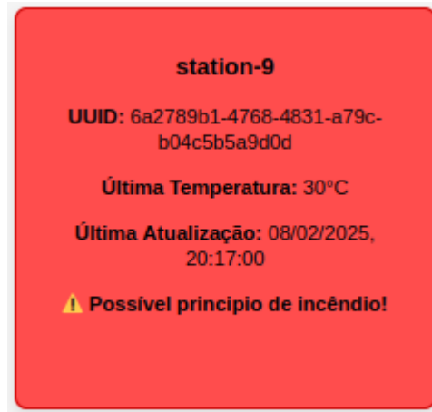
Figura 15 - Card em alerta de princípio de incêndio
