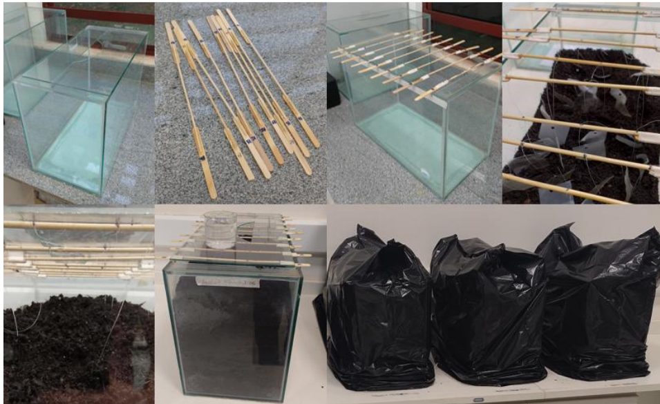
Figura 13: Montagem do sistema utilizado nos ensaios de aterramento em solo. Fonte: Próprio autor.
