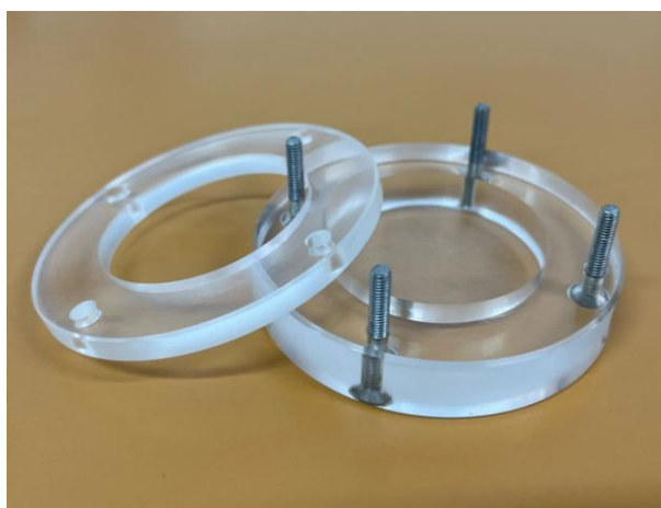
Figura 12: Célula utilizada nos ensaios de permeabilidade à água. Fonte: próprio autor.
