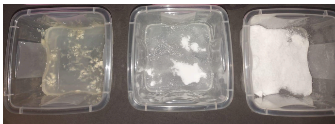
Figura 5. Intumescimento dos polímeros em solução aquosa. Fonte: Elaborado pelo próprio autor (2025).
