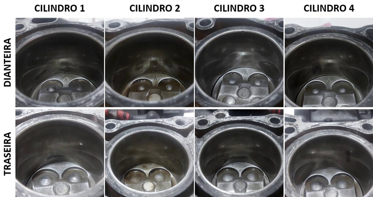
Figura 19: Imagens das camisas das câmaras de combustão após falha. Fonte: própria (2024).
