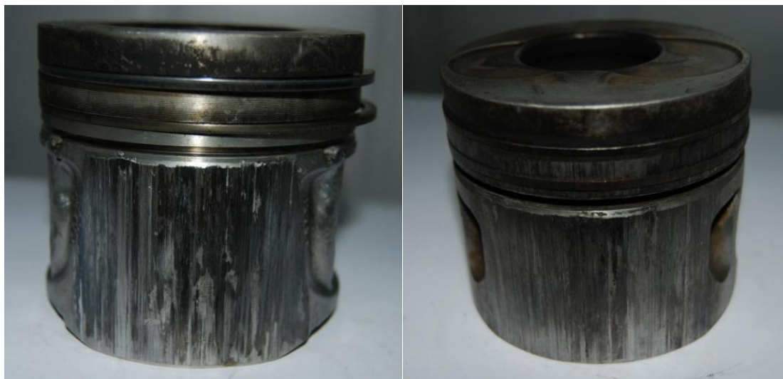
Figura 7: falha por desgaste da saia do pistão (TOMASZ; PIOTR, 2015b).
