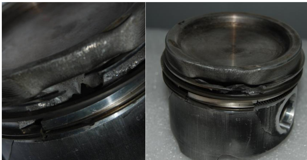
Figura 4: Falha por fusão na cabeça do pistão (TOMASZ; PIOTR, 2015b).
