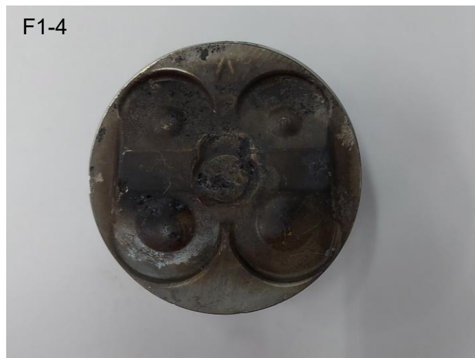
Figura 13: Fusão da cabeça de pistão Fonte: própria (2024).
