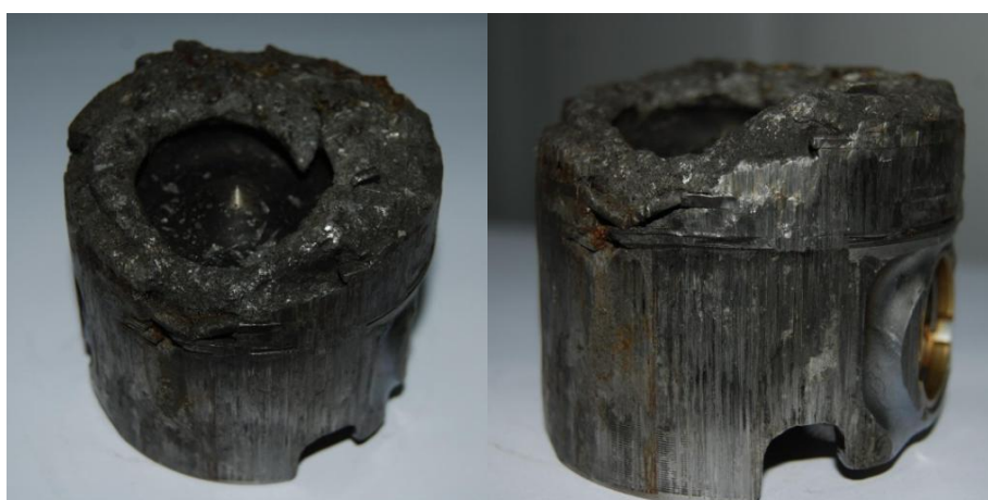
Figura 6: Falha por fusão da cabeça do pistão e da área do anel (TOMASZ; PIOTR, 2015b).
