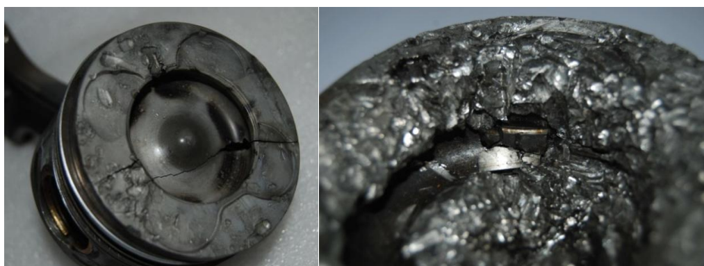
Figura 5: Falha por danos mecânicos em cabeça do pistão (TOMASZ; PIOTR, 2015b).
