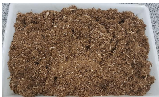
Figura 2 - Casca de Eucalyptus seca e triturada utilizada para análises de caracterização e produção do biochar
