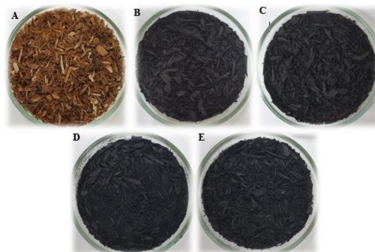
Figura 3 - Fotos da casca de Eucalyptus in natura – CE (A) e dos tratamentos: B300 (B), B350 (C), B400 (D) e B450 (E)
