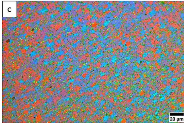
Figura 24: Micrografias das regiões (a) não consolidada ou compactada; (b) parcialmente consolidada; (c) totalmente consolidada, da amostra 290 (liga Al6Cu2Li).
