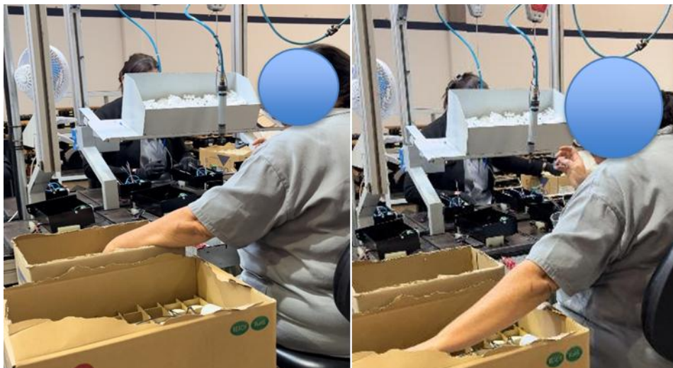
Figura 15: Melhora das condições de trabalho para pegar as peças da 1ª caixa, melhorando a área de alcance de pega e melhora das condições de trabalho para pegar as peças da 2ª caixa, evitando posturas e movimentos inadequados de ombros e coluna (após intervenções ergonômicas)
