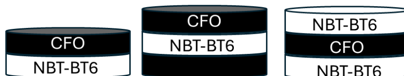
Figura 3.3: Configuração das amostras dos compósitos laminados do tipo bicamada – NBT-BT6/CFO e do tipo sanduíche – CFO/NBT-BT6/CFO e BNT-BT6/CFO/BNT-BT6.
