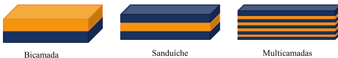
Figura 3.1: Estruturas bicamada, sanduíche e multimacadas dos compósitos 2-2.
