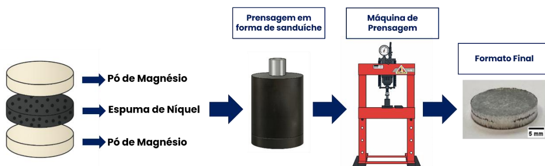
Figura 4.3: Representação de amostra de pó de Mg e espuma de Ni em camadas e após prensagem (em forma de sanduíche).
