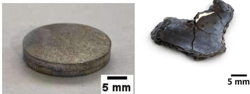
Figura 5.1: Amostras de liga Mg–22% em peso de Ni sinterizadas a (a) 480°C e (b) 530°C.
