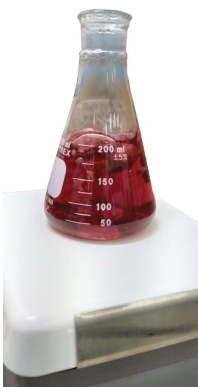
FIGURA 3.6.1-Foto da síntese das nanopartículas de ouro estabilizadas com citrato em ebulição.
