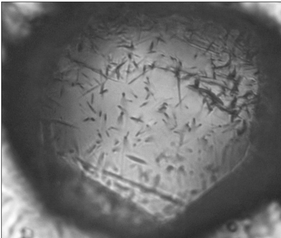
Figura 7 - Grão de zircão e seus traços de fissão visualizados através de microscopia óptica.
