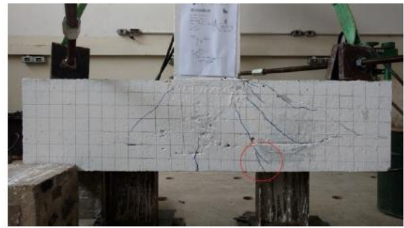
(b) Plano de ruptura do modelo Bem10cch (bloco com embutimento de 10 cm com chapa)
