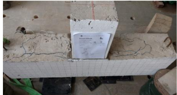
(b) Plano de ruptura do modelo Bem30sch (bloco com embutimento de 30 cm sem chapa).
