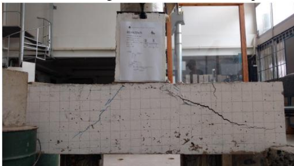
(a) Plano de ruptura do modelo Bem20sch (bloco com embutimento de 20 cm sem chapa).
