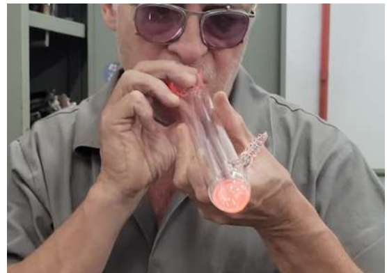
Figura 20 - d) Técnica de sopro aplicada ao condensador
