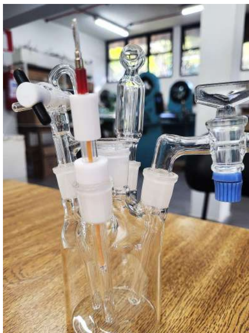
Figura 16 - c) Reator finalizado com todas as suas conexões e peças necessárias
