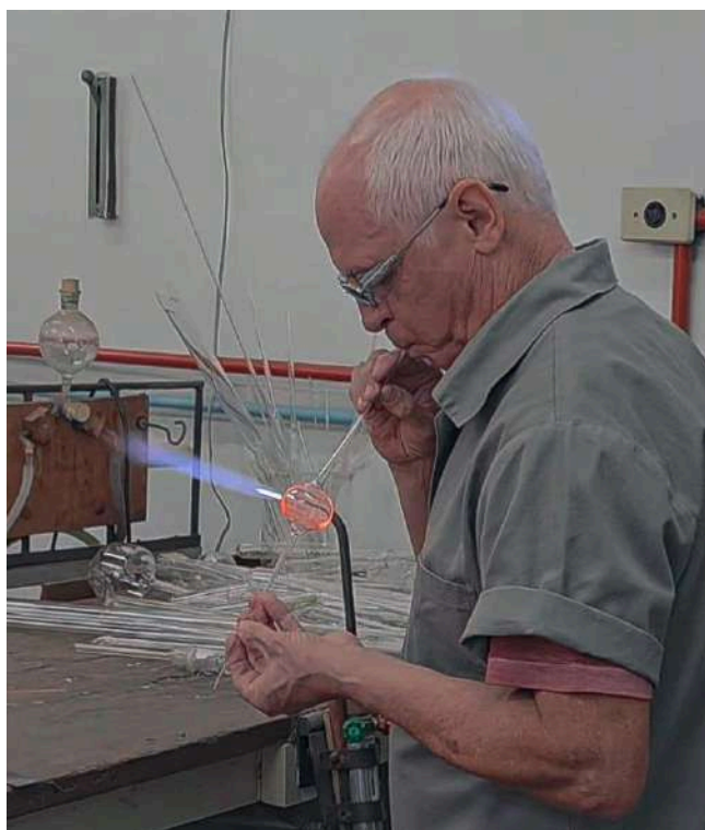
Figura 11 - Hialotécnico Ademir Sertori realizando a técnica de sopro para moldar o vidro ao maçarico.
