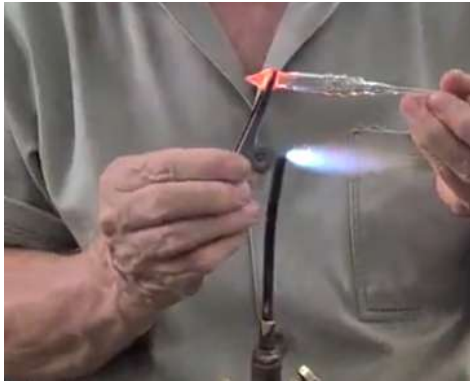
Figura 20 - a) Confeção da oliva soldada ao condensador
