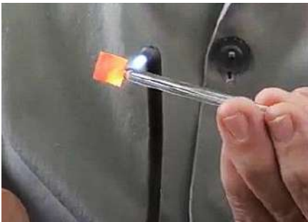
Figura 19 - c) Solda da placa de platina ao eletrodo
