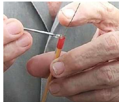
Figura 19 - d) Aplicação do adesivo epóxi na extremidade do eletrodo
