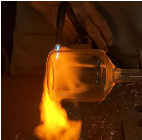
Figura 16 - a) Preparação do corpo do reator
