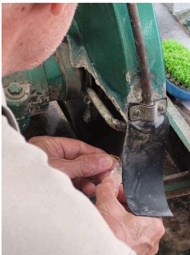
Figura 13 - Uso de serra diamantada para corte em vidro
