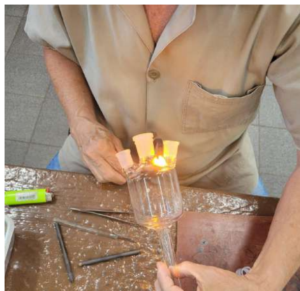
Figura 16 - b) Solda das juntas ao reator
