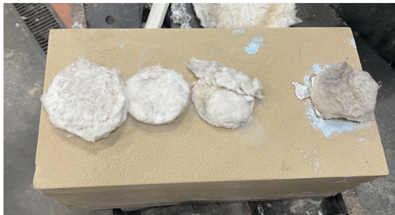
Figura 28 - Posicionamento das mantas térmicas cobrindo o topo dos massalotes. Fonte: Autoral.
