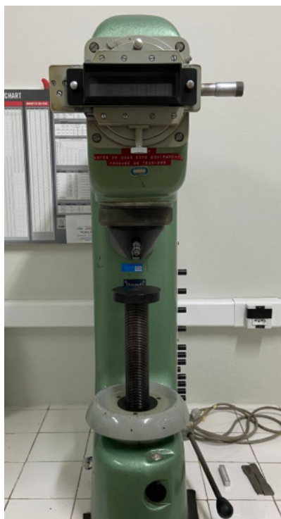
Figura 12 - Durômetro Brinell utilizado. Fonte: Autoral.
