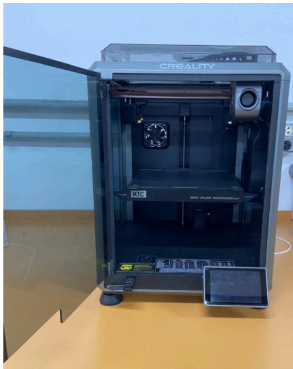
Figura 9 - Impressora 3D utilizada para a impressão do modelo, canais de alimentação e massalotes do projeto. Fonte: Autoral.
