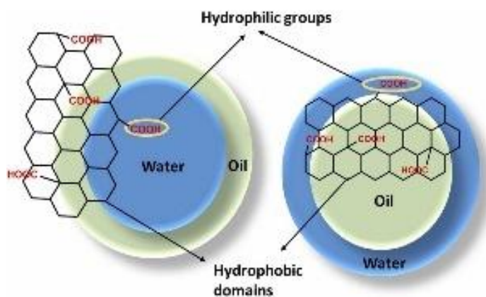
Figura 3. Interação do GO na interface água-petróleo, alterando as propriedades de tensão interfacial
